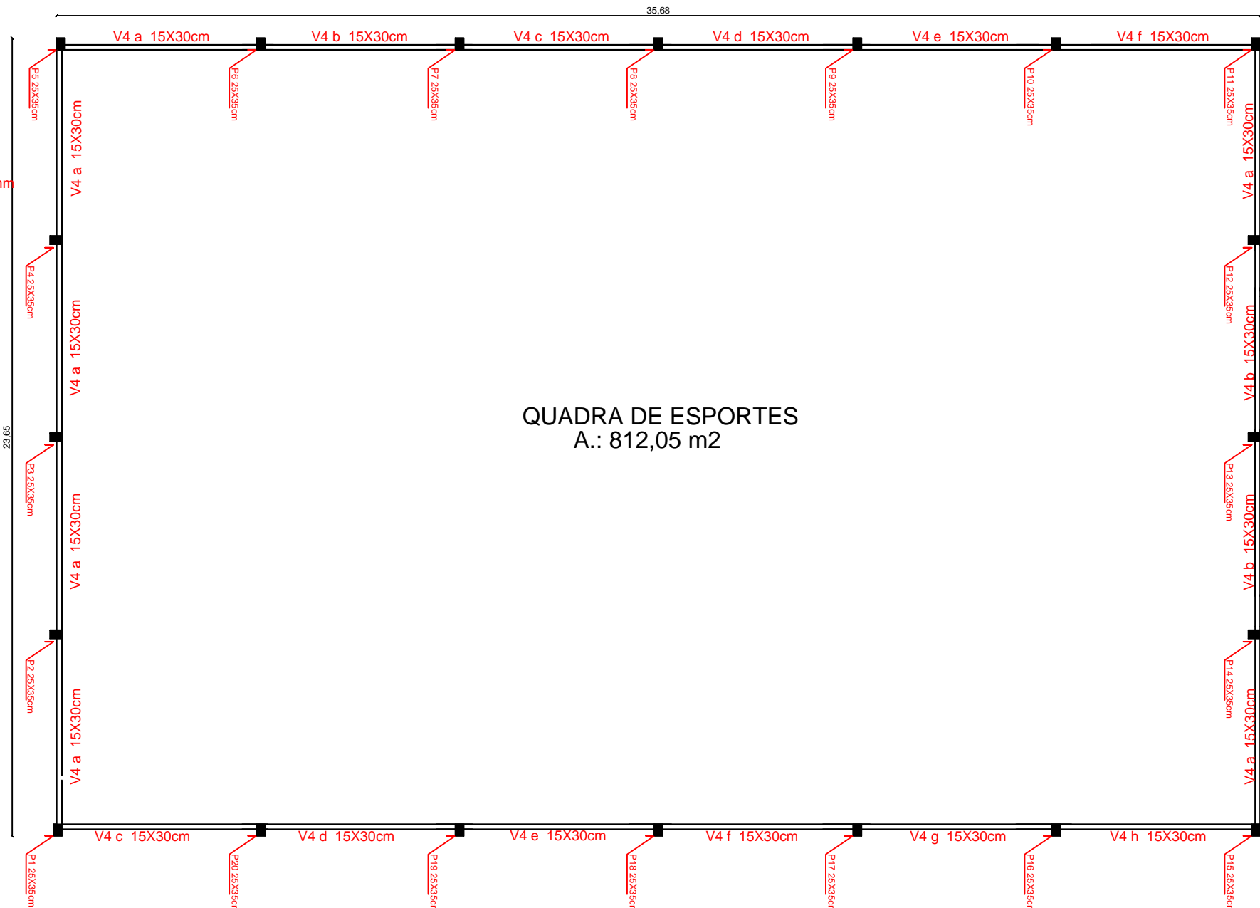
PLANTA DE FORMAS - SUPRAESTRUTURA - viga superior Esc.: Sem Escala
