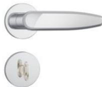
Conjunto de fechadura de embutir para porta de banheiro, cromada, chave tipo tranqueta, sem cilindro, máquina com broca de 55 mm, completa (máquina, contra testa, rosetas, acessórios plásticos, maçanetas, parafusos, chaves e outros necessários). Maçaneta tipo alavanca reta simples e rosetas redondas em metal cromado. Padrão de acabamento médio, ainda nas linhas mais básicas (não luxo). Conjunto utilizado nas portas de banheiros.
