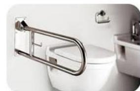
**Barra de apoio articulada**, com trava, fabricada em aço inox, com acabamento polido. O diâmetro mínimo deve ser de 3cm, usualmente encontrada com 3,175cm ou 1 1/2 polegadas. Utilizadas para apoio de pessoas com deficiência e idosos, são fixadas nas paredes de banheiros. Devem suportar carga mínima de 1,5kN ou 152,96kg.
