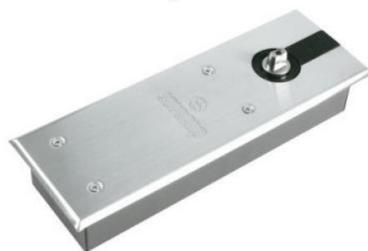
Mola de piso hidráulica para porta de vidro temperado com espessura de 10mm, também pode ser usada em portas de madeira ou metal. Porta padrão com largura máxima até 1100mm, altura de 2200mm, eixos intercambiáveis, instalação embutida. Permite ajustes verticais. Ajuste de força na válvula.
