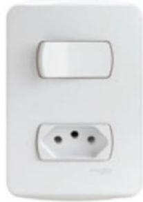
Conjunto montado para embutir. Agrega dois módulos (1 interruptor simples e 1 tomada 10 A, padrão NBR 14136), suporte para placa e placa com dois postos. Insumo deve ser coletado com base na linha básica do respectivo fabricante, vide exemplos no campo "Referência/Parâmetro de coleta", a linha coletada deve ser modular (módulo(s) + suporte + placa).
