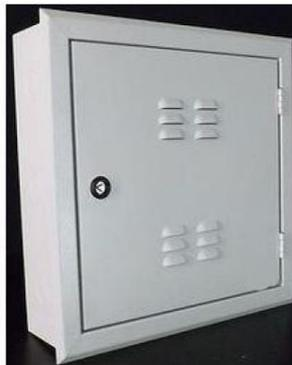
Caixa de telefonia - padrão Telebrás, N3, fabricada em chapa de aço galvanizado, com porta com dobradiça e trinco/fecho. Pintura eletrostática a pó. Não inclui o barramento. Profundidade aproximada de 12 cm. De embutir na parede, é destinada a organizar e dar passagem aos cabos e fios telefônicos.
