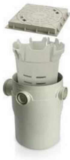
Caixa de gordura em PVC, cor cinza, com tampa, diâmetro mínimo de 300mm, diâmetro da saída com bitola de 100mm, diâmetros de entrada de 75mm ou 50mm. Capacidade aproximada de 18 litros, com cesto de limpeza removível. Serve para receber o esgoto proveniente do ramal da cozinha, age como filtro retendo a gordura dentro da caixa, impedindo que seja conduzida pela tubulação.
