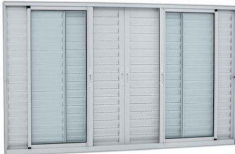
Esquadria em alumínio anodizado branco (pintura eletrostática a pó) ou brilhante. Fornecida com ferragens e vidros. Esquadria com 6 folhas móveis, sendo 4 venezianas externas e 2 de vidros sem divisão, sem grades e sem bandeira. Vidro encaixilhado, comum, liso/plano, translúcido, de 3 a 4 mm de espessura. Não inclui guarnição/arremate/moldura de acabamento.
