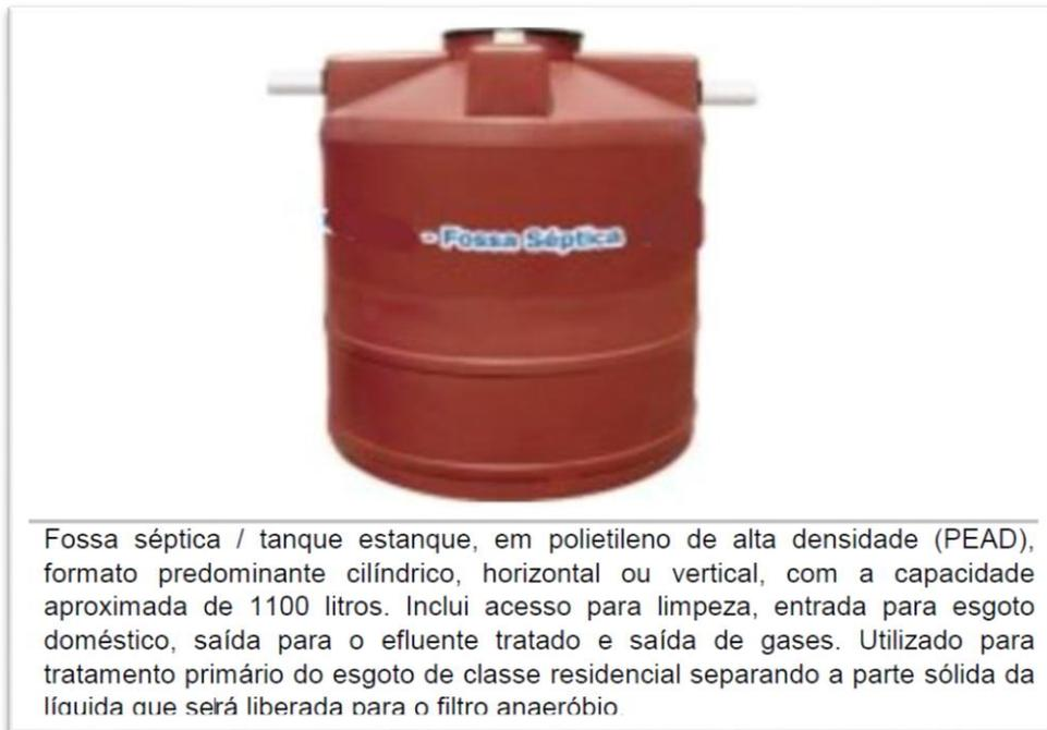
Fossa s ptica / tanque estanque, em polietileno de alta densidade (PEAD), formato predominante cil ndrico, horizontal ou vertical, com a capacidade aproximada de 1100 litros. Inclui acesso para limpeza, entrada para esgoto dom stico, sa da para o efluente tratado e sa da de gases. Utilizado para tratamento prim rio do esgoto de classe residencial separando a parte s lida da l quida que ser  liberada para o filtro anaer bio.
