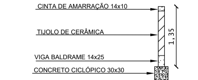
DETALHAMENTO EM CORTE DO MURO BB ESC.: 1:50
